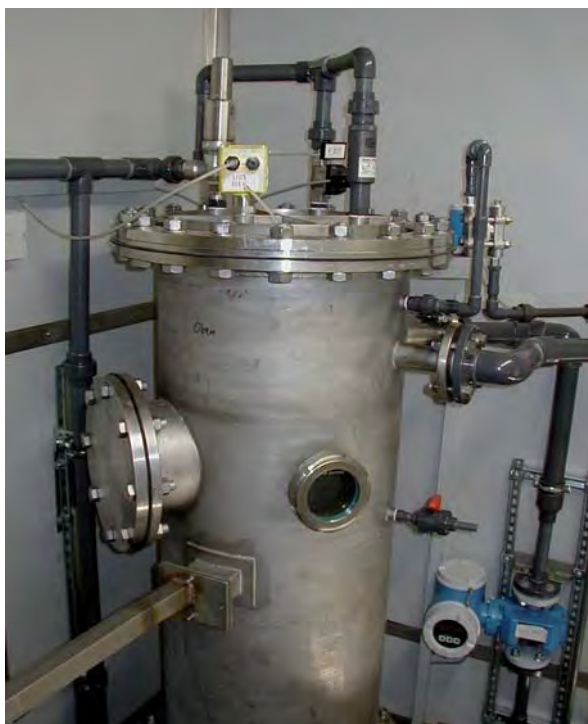
Reaktor zur biologischen Nitratentfernung (Denitrifikation)
