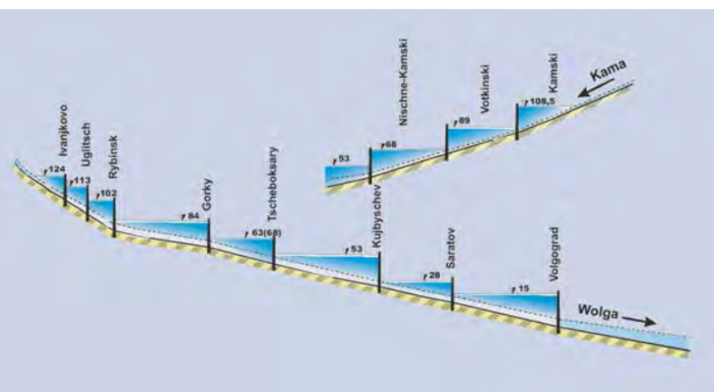
Längsschnitt der Wolga- und der Kama-Staustufenkette
