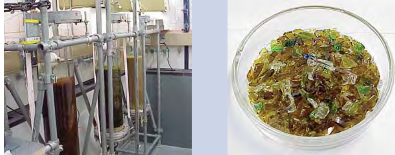
Säulenversuchsanlage in einer Klimakammer
