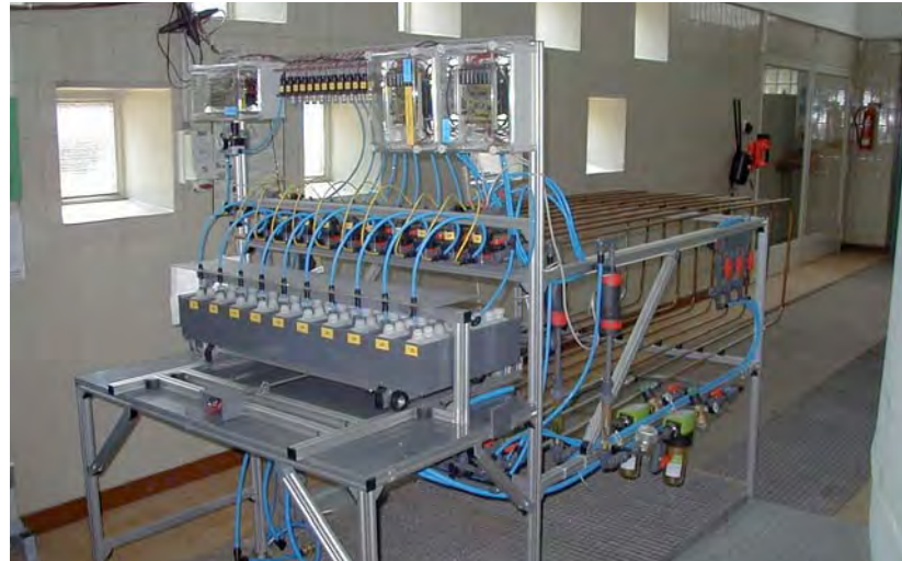
Transportabler Versuchsstand zur Bewertung des Einflusses der Wasserbeschaffenheit auf die Korrosion vor Ort
