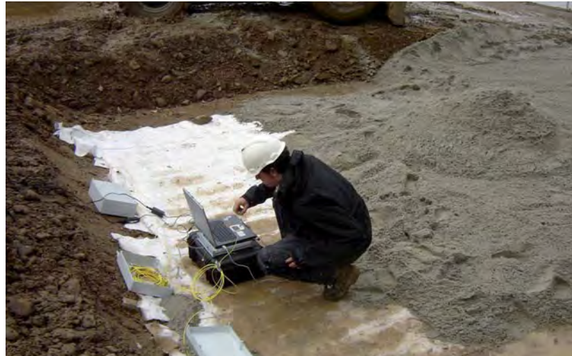
Kontrollmessung an einer sensorbasierten Geotextilfläche beim Applikationsprozess im Feldversuch in Swienna Poremba (Polen)
