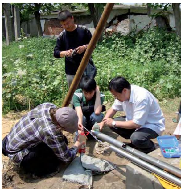
Testen von Probenahmetechnik an einer Grundwassermessstelle
