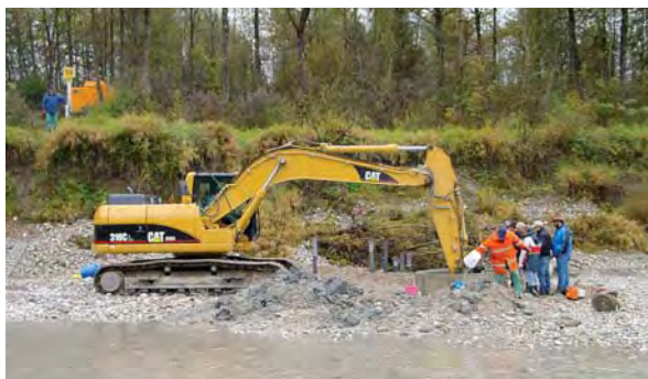
Sedimentprobenahme an der Salzach
